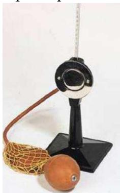
**1. Конденсационный гигрометр.** Состоит из укрепленной на подставке металлической круглой коробочки с отполированной плоской поверхностью. В коробочке сверху имеются два отверстия. Через одно из них в коробочку наливают эфир и вставляют термометр, а другое соединяют с резиновой грушей. Действие конденсационного гигрометра основано на определении точки росы (Рисунок 9).
