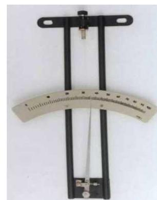
Рисунок 11 - Волосной гигрометр
